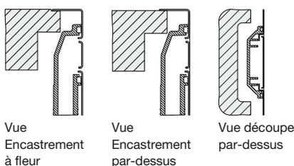
L'installation de cuves BLANCO CLARON IF avec trop-plein C-overflow nécessite une découpe dans l'épaisseur du plan de travail.
