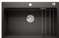
2 ETAGON-Schienen aus Edelstahl, Ablaufgarnitur mit Raumsparrohr, 3 1/2" InFino-Korbventil mit Ablauffernbedienung (Zugknopf chrom)
