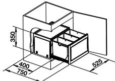
**System zur Bodenmontage hinter Drehtüren, zur händischen Bedienung**
