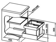
Das System für den Einbau in vorhandene Auszüge, **es wird daher ein Auszug mit Front vom Küchenhersteller benötigt**. Einbauhöhe 370mm ab Oberkante Schubkastenboden, Einbautiefe 400mm, Maximale Zargenhöhe 265mm, Systemabdeckung = Ablageboden zur Montage im Spülenschrank inkl. Für Kasettentüren ab 90 mm Rahmen geeignet
