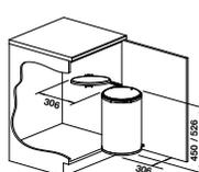
**System zur Montage an Drehtüren ohne Dämpfung**, Eimerdeckel
