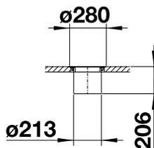
**System zur Montage in Arbeitsplatten**, aufliegender und flächenbündiger Einbau möglich, im Lieferumfang ist ein Deckel, 71 Eimer und Abdeckung aus Edelstahl enthalten
