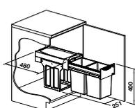
**System zur Bodenmontage hinter Drehtüren, zur händischen Bedienung**
