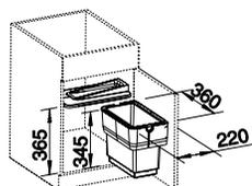
**System zur Montage an Drehtüren**, Eimerdeckel
