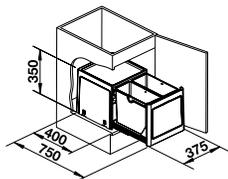
**System zur Bodenmontage hinter Drehtüren, zur händischen Bedienung**
