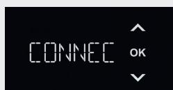
Depois de confirmar com 'OK', o aparelho apresenta 'CON OFF'. As teclas de seta permitem mudar para 'CON ON', 'CON RES' ou 'BACK' e confirmar com 'OK'. Ao selecionar 'BACK' e confirmar com 'OK', regressa ao menu.
