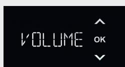
Für das Starten der Kalibrierung 'OK' 3 Sekunden gedrückt halten. Die Kalibrierungsroutine startet dann automatisch und Sie können damit die Mengenabgaben neu einstellen (siehe S. 23). Das Drehrad an der Armatur darf beim Start des Kalibriervorgangs nicht auf '0' stehen.
