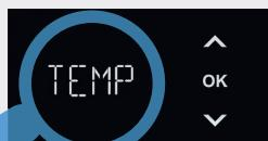
Después de confirmar con 'OK', se muestra la temperatura deseada ajustada en la unidad de refrigeración y carbonatación, la cual puede modificarse entre 4 y 10 °C con las teclas de flecha. Hay que tener en cuenta: el aparato requiere un poco de tiempo para alcanzar la temperatura ajustada.
