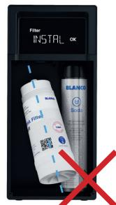
Enroscar el filtro con dos vueltas, aproximadamente. Al insertar el nuevo filtro, será necesario asegurarse de que se está colocando recto, no torcido. En caso necesario, el filtro del aparato puede inclinarse hacia delante para enroscarse y desenroscarse.
