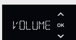
Para iniciar a calibração, premir 'OK' durante 3 segundos. A rotina de calibração inicia automaticamente e pode ser utilizada para repor a quantidade dispensada (ver pág. 183). O seletor rotativo na torneira não pode ser colocado em '0' ao iniciar o processo de calibração.
