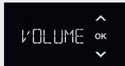
Pour lancer l'étalonnage, maintenez le bouton 'OK' enfoncé pendant 3 secondes. Le processus d'étalonnage démarre alors automatiquement et vous pouvez réinitialiser le volume de distribution (voir p. 80). La manette rotative du mitigeur ne doit pas être réglée sur '0' au début du processus d'étalonnage.
