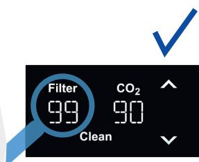
A vida útil restante do filtro é reposta e volta a apresentar 99 %. O sistema está limpo e pronto a funcionar novamente.
