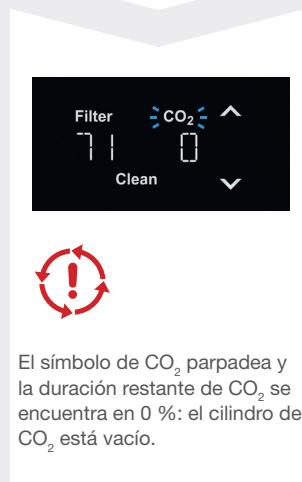
Por lo general, el cilindro de CO<sub>2</sub> aún tiene una cantidad residual de CO<sub>2</sub>, a pesar de que la indicación muestre 0 %. Por lo tanto, el aparato puede seguir usándose mientras no se produzca un cambio negativo en el resultado del agua con gas. En caso de que el contenido de ácido carbónico se redujera considerablemente o la presión del agua con gas no fuese suficiente, será necesario cambiar el cilindro sin demora.
