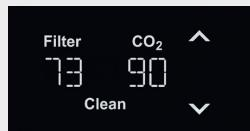
Visualizzazione della modalità di funzionamento normale, della capacità rimanente del filtro e di CO<sub>2</sub> (in %). Il numero a sinistra mostra la capacità rimanente del filtro. Il numero a destra mostra la capacità rimanente della bombola di CO<sub>2</sub>.
