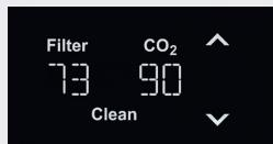
Estado de funcionamento normal com indicação da vida útil restante do filtro e do CO<sub>2</sub> (em %). O número da esquerda apresenta a vida útil restante do filtro. O número à direita mostra a capacidade restante dagarrafa de CO<sub>2</sub>.
