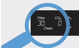
Controllare il display: è necessario sostituire la bombola di CO<sub>2</sub> (0 %) (p. 114) oppure bisogna effettuare a breve la pulizia e la sostituzione del filtro (10 %).
