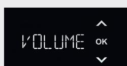
Per avviare la taratura, tenere premuto il pulsante 'OK' per 3 secondi. La procedura di taratura si avvierà automaticamente e sarà possibile reimpostare il volume di erogazione (vedere pag. 112). La rotella di regolazione del miscelatore non deve essere impostata su '0' all'avvio del processo di taratura.
