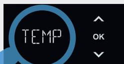
Depois de confirmar com 'OK', a temperatura-nominal definida é apresentada na unidade de refrigeração e carbonatação, que pode ser alterada entre 4 e 10 °C utilizando as teclas de seta. Observar: O aparelho necessita de algum tempo para atingir a temperatura definida.
