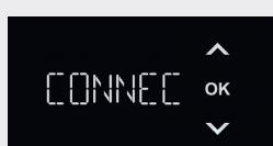
Nach Bestätigen mit 'OK' zeigt das Gerät 'CON OFF' an. Mit den Pfeiltasten kann auf 'CON ON', 'CON RES' oder 'BACK' verändert und mit 'OK' bestätigt werden. Durch Auswahl von 'BACK' und der Bestätigung mit 'OK' gelangt man zurück ins Menü.
