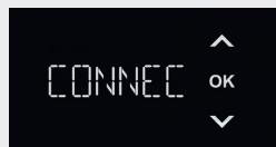
Après avoir confirmé avec 'OK', l'appareil affiche 'CON OFF'. Les touches fléchées permettent de sélectionner 'CON ON', 'CON RES' ou 'BACK' et de confirmer avec 'OK'. Sélectionner 'BACK' et confirmer avec 'OK' pour revenir au menu.
