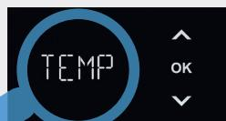
Après avoir confirmé en appuyant sur 'OK', la température cible choisie dans l'unité de refroidissement et de gazéification est affichée et peut être réglée entre 4 et 10 °C à l'aide des flèches. Veuillez noter : l'appareil prend un peu de temps pour atteindre la température choisie.
