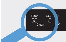
Bitte Display prüfen: Wechsel CO<sub>2</sub>-Zylinder (0 %) erforderlich (S. 17) oder Reinigung und Filterwechsel (10 %) müssen bald durchgeführt werden.
