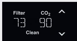
Estado de funcionamiento normal con indicación de la duración restante del filtro y de CO<sub>2</sub> (en %). La cifra izquierda indica la duración restante del filtro. La cifra derecha indica la capacidad restante del cilindro de CO<sub>2</sub>.
