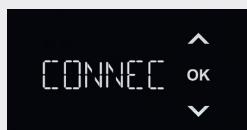
Después de confirmar con 'OK', el aparato indica 'CON OFF'. Con las teclas de flecha puede comutar a 'CON ON', 'CON RES' o 'BACK' y confirmar con 'OK'. Para volver al menú, seleccione 'BACK' y confirme con 'OK'.
