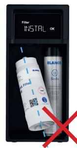
Den Filter mit etwa zwei Umdrehungen einschrauben. Beim Einsetzen des neuen Filters darauf achten, dass er gerade eingesetzt wird, nicht schräg! Sie können zum Ein- und Ausschrauben den Filter jedoch im Gerät nach vorne kippen.
