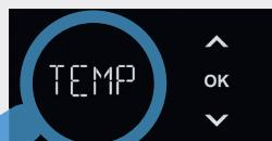
Dopo aver confermato con 'OK', viene visualizzata la temperatura desiderata impostata nell'elemento refrigerante e di gasatura, che può essere impostata tra 4 e 10 °C utilizzando i tasti freccia.
