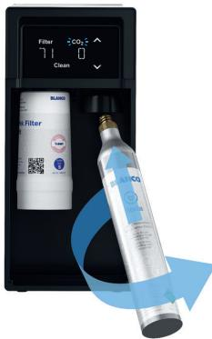
Die richtige Position ist wichtig: Beim Einsetzen den Zylinder bis zum mechanischen Anschlag in das Gewinde eindrehen. Anschließend etwa noch eine weitere 1/4-Drehung nachdrehen, so dass der Zylinder fest sitzt.
