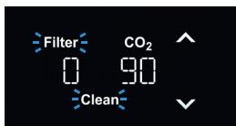
Wenn die Filterlaufzeit zu Ende oder eine Reinigung erforderlich ist, blinken die „Clean“- und „Filter“-Symbole. Das System muss gereinigt und ein neuer Filter eingesetzt werden.
