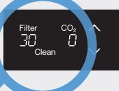
Controllare il display: è necessario sostituire la bombola di CO<sub>2</sub> (0 %) (p. 133) oppure bisogna effettuare a breve la pulizia e la sostituzione del filtro (10 %).
