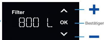
Filterkapazität in den Filterunterlagen ablesen. Zahl manuell eingeben. Mit „OK“ bestätigen.
