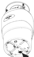
Position des Reset-Schalters
