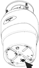
Position des Reset-Schalters
